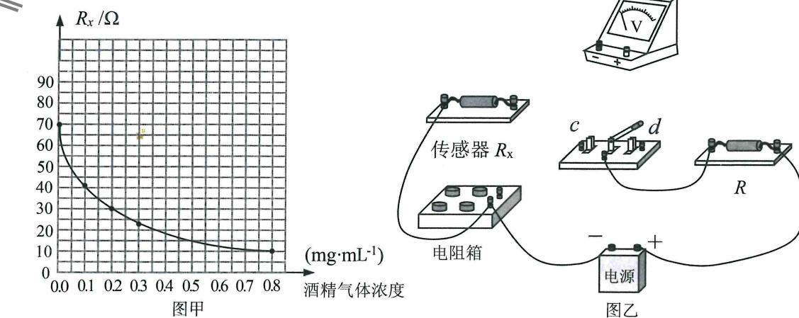
(2) 电路中  $R$  应选用定值电阻 \_\_\_\_\_ (填“ $R_1$ ”或“ $R_2$ ”)。
